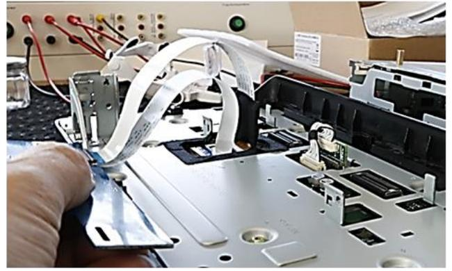
Die Flexleitung „OUT“ des Tochter PCB am Flexleitungssockel der Werks Monitor Platine anschließen und die Werks-Flexleitung am Flexleitungsverbinder der Tochter PCB Flexleitung „IN“ anschließen.
