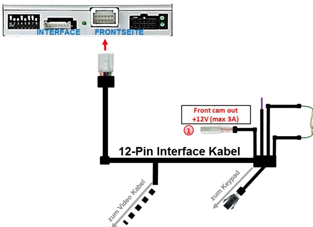
① Der rote Stromversorgungsanschluss **Front cam out +12V (max 3A)** kann zur Stromversorgung der Frontkamera mit Dip1 (der schwarzen 8 Dips) auf ON genutzt werden.
