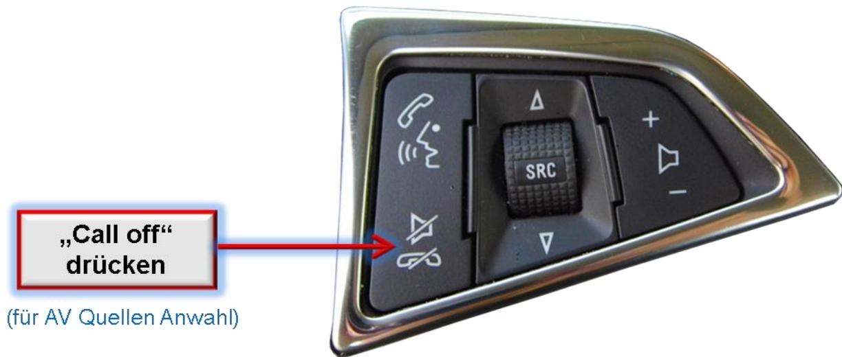
Die CALL OFF-Taste am Lenkrad schaltet den Eingang vom Werksvideo zu den eingespeisten Videoquellen um. Wenn alle Eingänge per Dip Switch Einstellung aktiviert sind, ist die Reihenfolge wie folgt:
