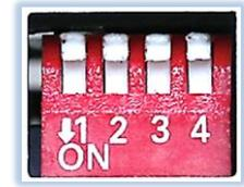
**Nach jeder Veränderung der Dip-Schalter-Einstellung muss ein Stromreset des Video Interface durchgeführt werden!**
