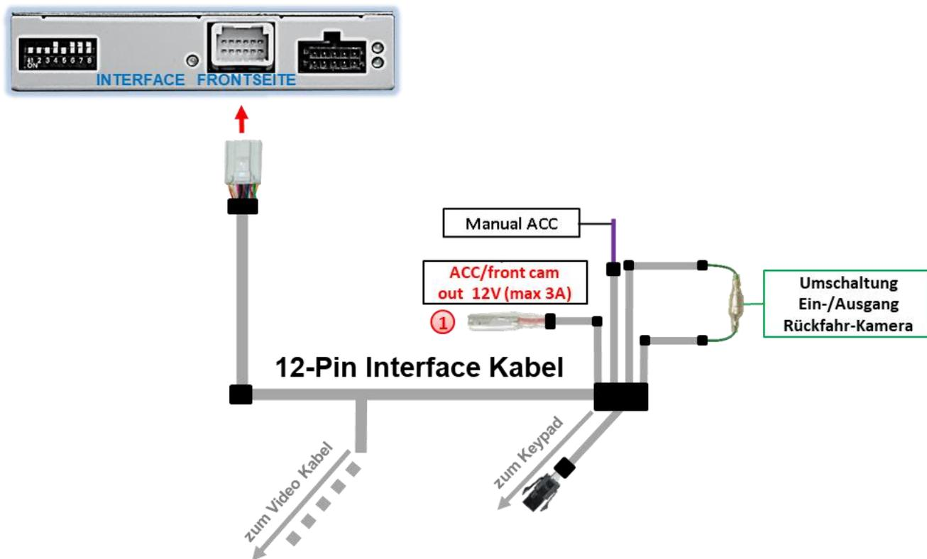
① Der rote Stromversorgungsanschluss **ACC/front cam out 12V (max 3A)** kann zur Stromversorgung einer externen Quelle genutzt werden und hat je nach Stellung von Dip Schalter 1 (der schwarzen 8 Dips) eine andere Belegung:
