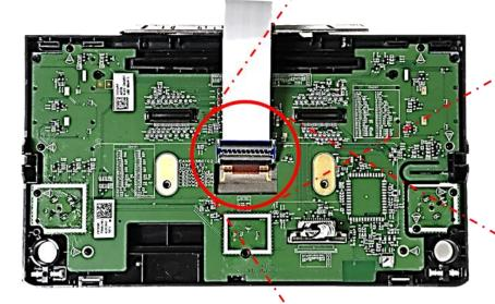
Um Kurzschlüsse durch Vibrationen auszuschließen muss der Flexleitungsverbinder rundherum mit einer Lage Gewebeband isoliert werden, wie in nebenstehendem Bild zu sehen.
