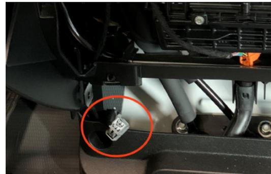
5. Verlegen Sie die Kabel für Geschwindigkeit und Rückwärtsgang vom Fadioschacht im Armaturenbrett bis zur Sicherungskasten. Die Drähte mit den blanken Enden verbleiben in der Öffnung des Armaturenbretts und werden am neuen Hauptgerät angeschlossen.
