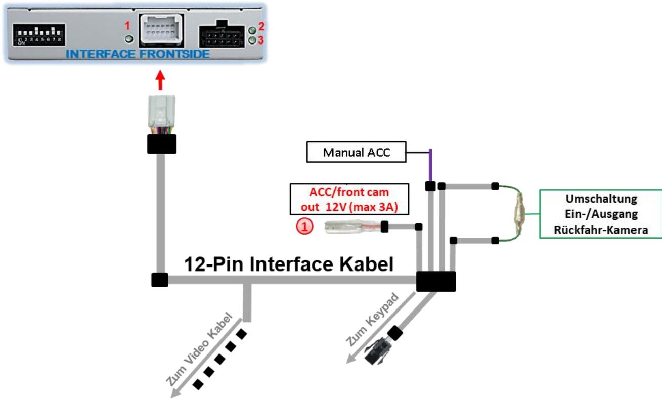
① Der rote Stromversorgungsausgang **ACC/front cam out 12V (max 3A)** kann zur Stromversorgung einer externen Quelle genutzt werden und hat je nach Stellung von Dipschalter 1 (der schwarzen 8 Dips) eine andere Belegung:
