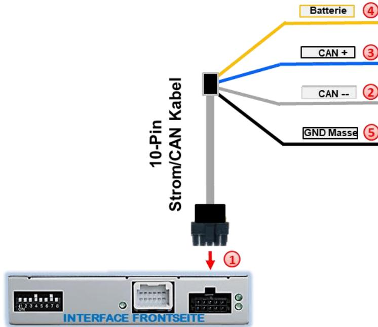
Der Anschluss von Strom und CAN muss am Quadlock auf der Rückseite der Head-Unit erfolgen!
