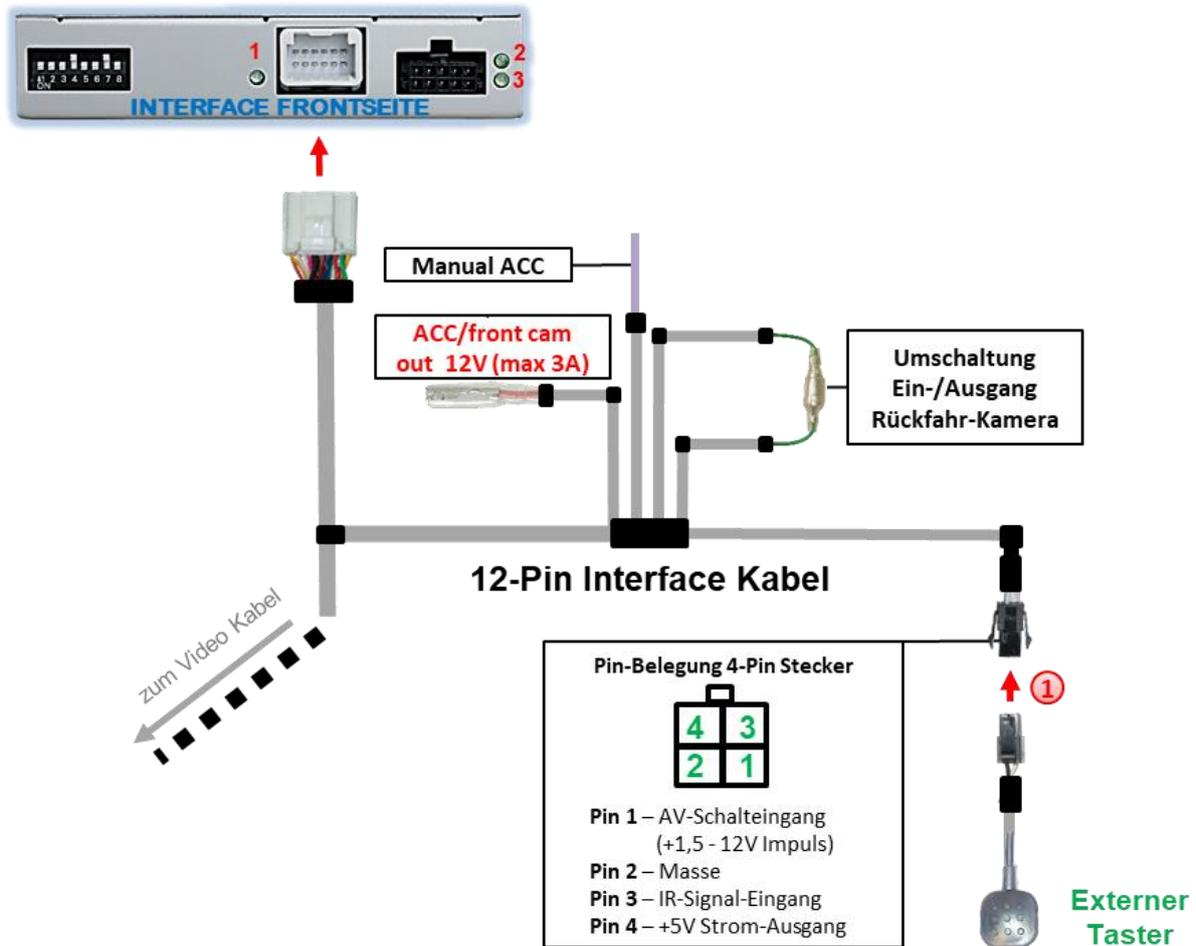
① Die 4-Pin Buchse des externen Tasters an dem 4-Pin Stecker des Video-Interface anschließen.
