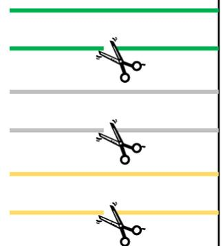
**Sollte die Isolation der Kameraleitung im Feuchtbereich nahe der Kamera bei Installation beschädigt werden, so muss die Isolation zwingend repariert werden, da sonst die Kamera bei Temperaturwechseln früher oder später Feuchtigkeit zieht.**
