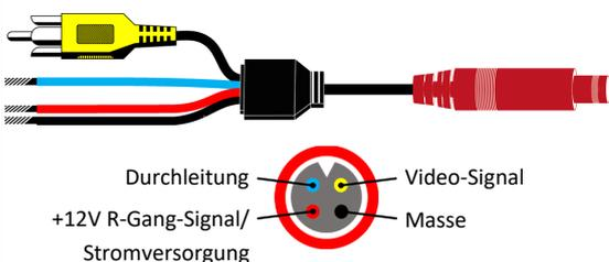
**Hinweis:** Bei Stromversorgung über Rückfahrleuchte empfehlen wir die Installation eines Relais zwischen Stromversorgung der Rückfahrleuchte und Kamerastromversorgung, um eine stabile und störungsfreie Stromversorgung zu gewährleisten und Telematik Fehlermeldungen zu vermeiden. Die **Durchleitung** kann benutzt werden um das Rückfahrtsignal vom Heck nach vorne zu leiten.
