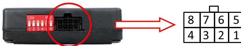
Pin-Belegung 8-Pin Stecker der TV-500
