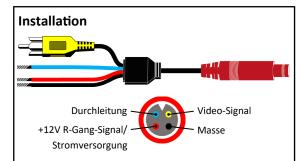
Hinweis: Bei Stromversorgung über Rückfahrleuchte empfehlen wir die Installation eines Relais zwischen Stromversorgung der Rückfahrleuchte und Kamerastromversorgung, um eine stabile und störungsfreie Stromversorgung zu gewährleisten und Telematik Fehlermeldungen zu vermeiden. Die **Durchleitung** kann benutzt werden um das Rückfahrsignal vom Heck nach vorne zu leiten.
