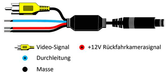
**Hinweis:** Bei Stromversorgung über Rückfahrleuchte empfehlen wir die Installation eines Relais zwischen Stromversorgung der Rückfahrleuchte und Kamera Stromversorgung, um eine stabile und störungsfreie Stromversorgung zu gewährleisten und ungewollte Fehlermeldungen im Bordcomputer zu vermeiden.
