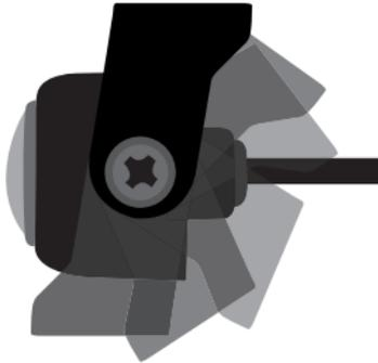
Befestigen Sie die Kamera entweder als Unterbau- oder Aufbaukamera an geeigneter Stelle. Der Bügel lässt sich mit 2 kleinen Schrauben in mehreren Positionen Verstellen.
