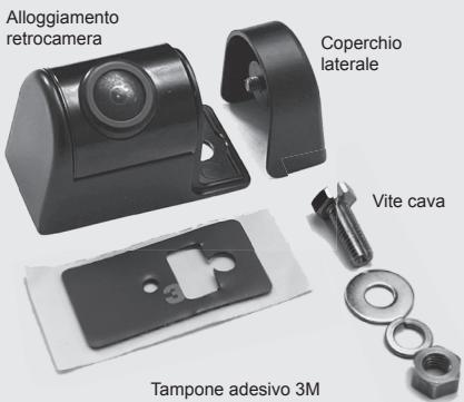
Inserire il cavo nella scanalatura della vite a filettatura cava. Instradare il cavo con la vite a filettatura cava nel foro rotondo nella base della telecamera. Praticare un foro passacavo di montaggio/cavo con un diametro di 6 mm. Fissare la telecamera tramite vite cava filettata con rondella, rondella elastica e controdado M6.
