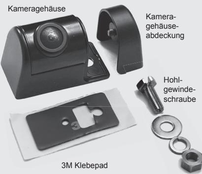
Führen Sie das Kabel in die Nut von der Hohlgewindeschraube ein. Fädeln Sie das Kabel mit der Hohlgewindeschraube in das runde Loch im Kameraboden ein. Bohren Sie ein Befestigungs- bzw. Kabeldurchführungsloch mit 6 mm Durchmesser. Schrauben Sie die Hohlgewindeschraube mit der U-Scheibe, Federscheibe und M6 Kontermutter an.
