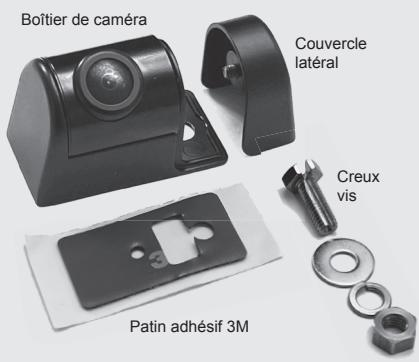
Insérez le câble dans la rainure de la vis à filetage creux. Acheminez le câble avec la vis à filetage creux dans le trou rond de la base de la caméra. Percer un support / câble trou de passage de câble d'un diamètre de 6 mm. Fixez la caméra à l'aide d'une vis à filetage creux avec rondelle, rondelle élastique et contre-écrou M6.
