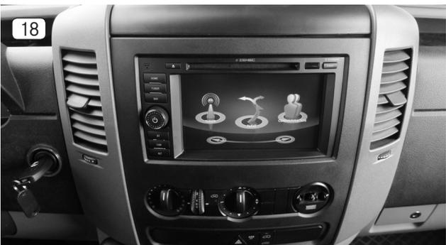
18. Nachdem das ZENEC-System verschraubt wurde, müssen Sie wieder die Radioblende aufstecken. Stecken Sie die Stecker der Tastenfelder wieder ein (falls vorhanden).
