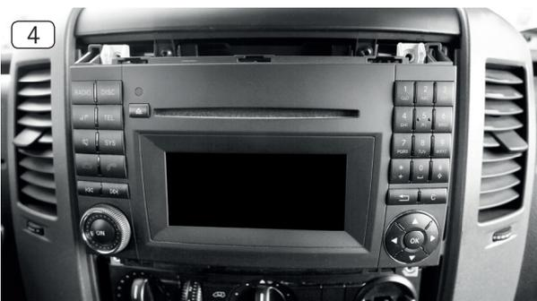
4. Ziehen Sie das Originalgerät nun vorsichtig aus dem Radioschacht. Stecken Sie anschließend alle Kabel an der Geräterückseite aus und legen das Originalgerät auf die Seite.
