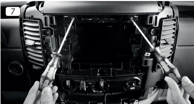
7. Entfernen Sie die beiden Torxschrauben (T25) der oberen Ablage.
