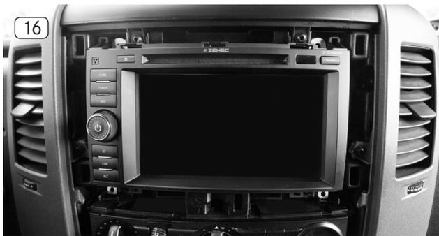
16. Verbinden Sie alle zuvor in den Radioschacht verlegten Kabel und das originale Antennenkabel mit dem ZENEC-System (Nr. 1).
