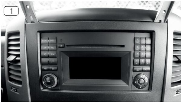
1. Hebeln Sie vorsichtig die das Originalgerät umgebende Radioblende aus seiner gesteckten Verankerung. Für diesen Schritt benötigen Sie ein Entriegelungswerkzeug aus Kunststoff.
