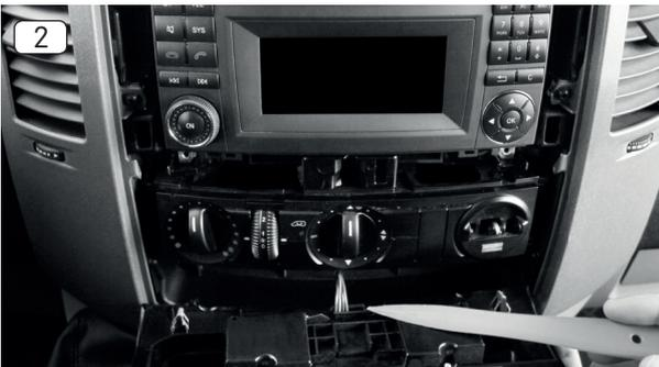
2. Bei Fahrzeugen mit Tastenfelder in der Radioblende ziehen Sie den Stecker des Tastenfeldes ab und legen die Radioblende auf die Seite.
