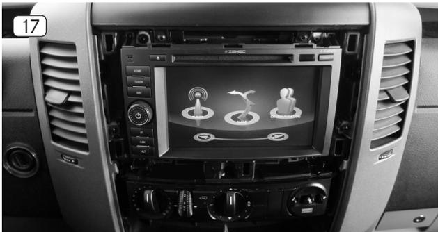
17. Verlegen Sie die diversen Anschlusskabel des ZENEC-Systems sorgfältig im unteren Bereich der Radioschachts. Schieben Sie anschließend das ZENEC-System vorsichtig und mit dosierter Kraftaufwendung zurück in den Radioschacht. Verschrauben Sie das ZENEC-System wieder mit den vier originalen Torxschrauben (T25).
