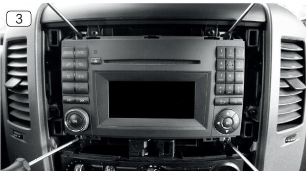
3. Lösen und entfernen Sie die vier Torx-schrauben (T25) vom Originalgerät.
