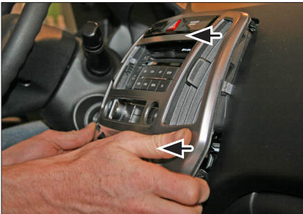
3. Remove OEM bezel
