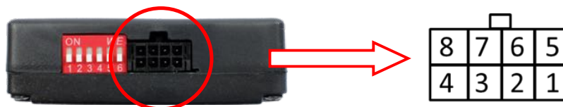
Pin-Belegung 8-Pin Stecker der TV-500
