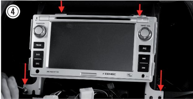
**4** Entfernen des Radios:
