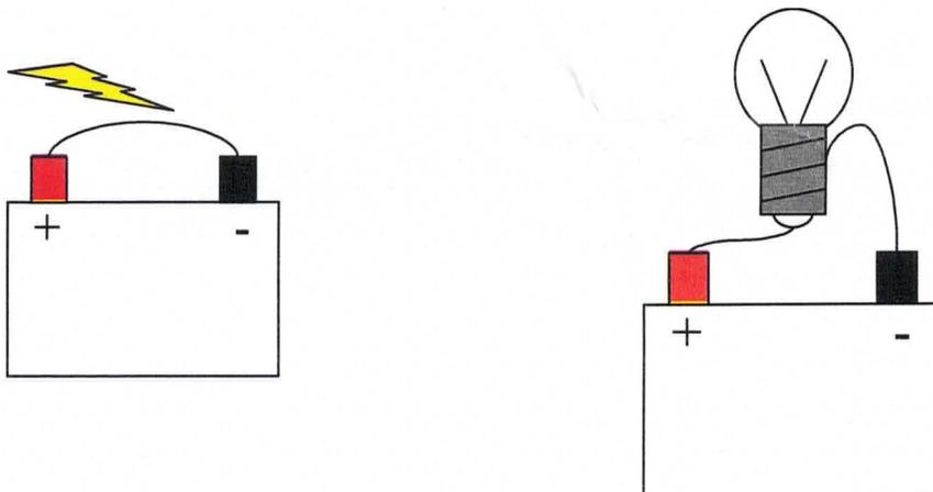
Im linken Bild führt die Verbindung beider Batteriepole zu einem Kurzschluss was zu starken Beschädigungen an der Batterie und zum verglühen des Kabels führen kann. Im rechten Bild wird durch den Einsatz der Glühlampe als Widerstand der Strom begrenzt. Die Verluste werden bei der Glühlampe in Wärme umgesetzt.
