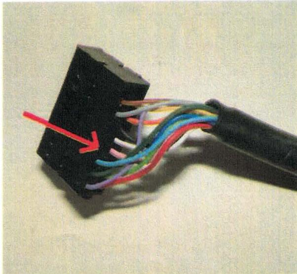
Der VSWITCH Anschluss befindet sich am Videostecker gegenüber des NORM Anschlusses (rosa Kabel). Ein Stecker der folgenden Ausführung oder ähnlich wird benötigt:
