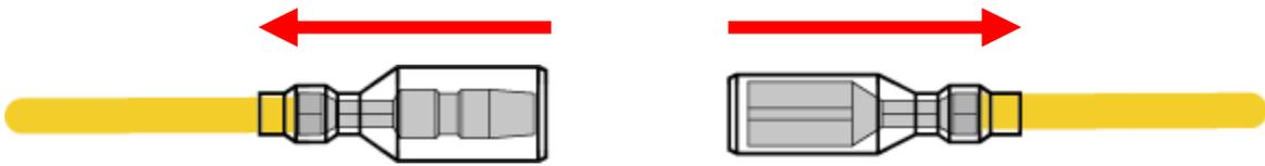
Das mitgelieferte gelbe Kabel mit dem Kabelsatz verbinden und das offene übrig gebliebene Ende mit einem Isolierband verschließen.
