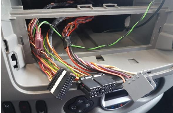
Monitoranschluss 24-pin Stecker / 24-way monitor connector
