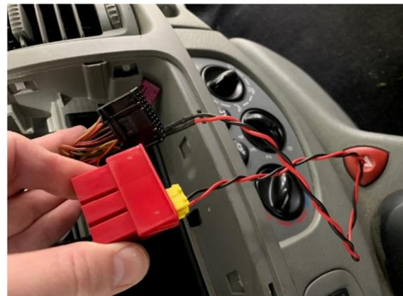
Das linke Bild zeigt eine vereinfachte Darstellung der Verbindung zwischen den Mini-Iso-Can Busleitungen vom RTA Adapter mit der Can Busleitung vom abgebildeten 24-pin Stecker. Mit dieser Verbindung funktioniert die Lenkradfernbedienung.
