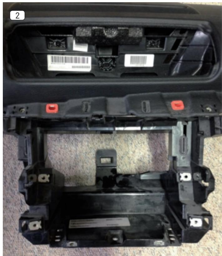
2 [DE] Entfernen Sie den Halterahmen aus Kunststoff.
