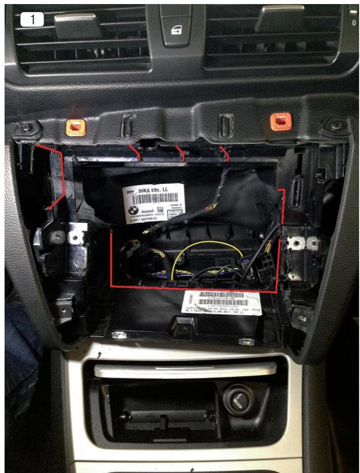
1 [DE] Demontieren Sie Zierleiste, Klimabedienteil und das Werksradio. Für die Montage des Z-N720 BMW OmniMask Kits muss der Radioschacht wie auf dem Bild zu sehen präpariert werden, was in den nachfolgenden Bearbeitungsschritten 2), 3) und 4) zu sehen ist.
