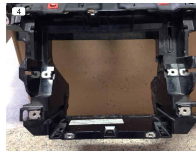
4 [DE] Der Radio Halterrahmen sollte nach erfolgter mechanischer Bearbeitung wie hier abgebildet aussehen.
