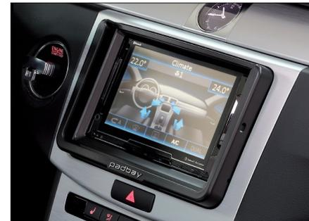
2. Verbinden Sie alle benötigten Anschlüsse bzw. Adapter. Schieben Sie das Autoradio in den dafür vorgesehenen Schacht. Setzen Sie die Padbay-Blende über das Autoradio und verschrauben Sie diese mit den Original-Torx (TX20) Schrauben. Führen Sie anschließend alle Ausbauschritte in umgekehrter
