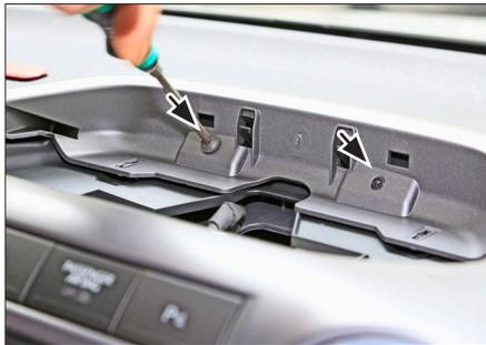
3. Lösen Sie beide Schrauben am oberen Rand der Ablagefachaussparung
