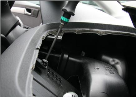
2. Entfernen Sie die Einlage des oberen Ablagefachs
