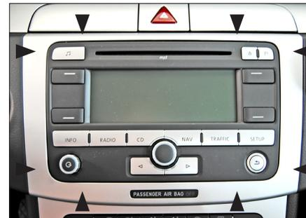
2. Entfernen Sie den OEM-Trim-Rahmen (mit Clips befestigt)
