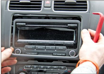
1. Entfernen Sie den OEM-Trim-Rahmen (mit Clips befestigt)
