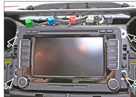
6. Lösen sie alle 4 Schrauben des OEM-Radios
