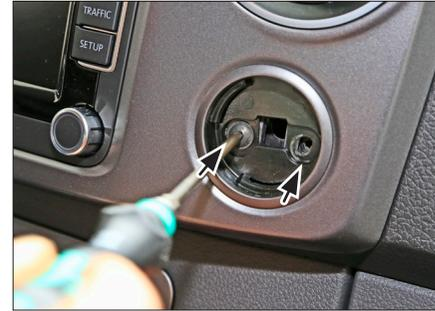
4. Lösen Sie alle Schrauben unter den vorher entfernten Blindstopfen
