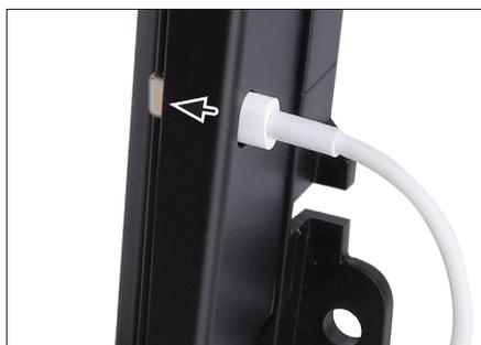
Führen Sie das Lightning-Kabel durch die obere Öffnung der Padbay-Blende um das iPad mini z.B. über einen externen USB-Anschluss laden zu können.
