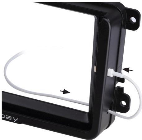
1. Schieben sie das Lightning-Kabel von hinten durch die untere Öffnung der Padbay Blende (siehe Pfeil unten)
