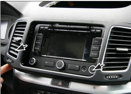
3. Entfernen Sie den OEM-Trim-Rahmen (mit Clips befestigt)
