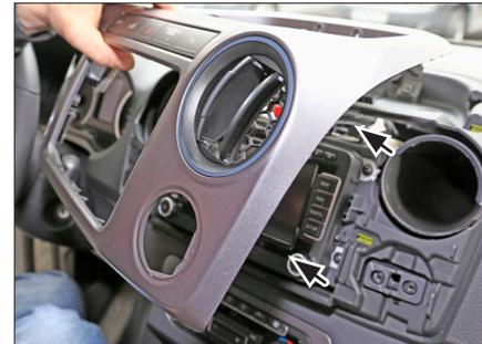
5. Frontblende ausclippen und alle Anschlusskabel der oberen Schalterleiste vorsichtig abziehen
