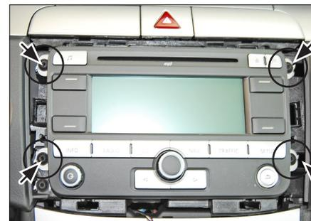
3. Entfernen Sie alle 4 Torx (TX20) Schrauben (diese werden später wieder benötigt)
