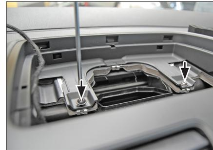
1. Ablagefach (mit Clips befestigt) anheben und die darunter befindlichen Schrauben entfernen. (siehe Pfeile)
