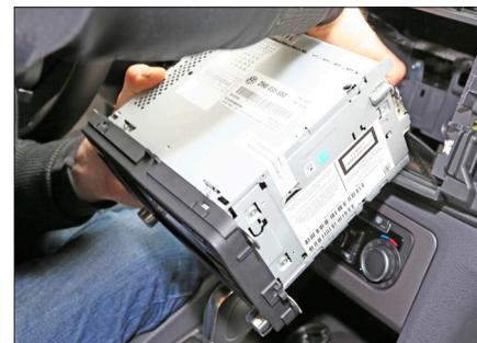
7. Lösen Sie vorsichtig alle Stecker und Anschlüsse des OEM-Autoradios. Ziehen Sie das OEM-Radio aus dem Einbauschacht.
