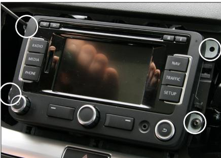
4. Entfernen Sie alle 4 Torx (TX20) Schrauben (diese werden später wieder benötigt)
