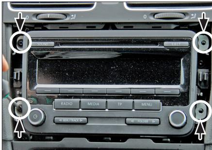
2. Entfernen Sie alle 4 Torx (TX20) Schrauben (diese werden später wieder benötigt)
