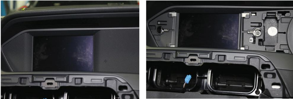
7. Zusammenbau der Armatur: Schrauben Sie beide Halterungen an beide Seiten des Panels welche im Einbausatz mitgeliefert sind. ( 2 x Schrauben - Artikel 7)
