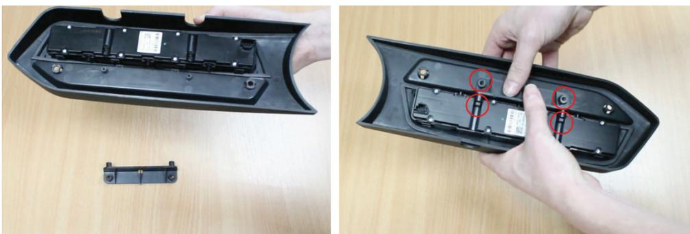
**15.** Legen Sie das Tastenfeld in die unten angezeigte Position. Schrauben Sie das Panel an und drücken Sie die Gummimatte in die entsprechende Position.
