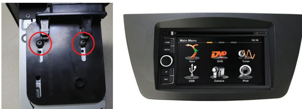
**9.** Lösen Sie die Clips und entfernen Sie das untere Displaypanel. Dieses gibt Ihnen mehr und einfacheren Zugang für das Einfügen des Verlängerungskabels in das Armaturenbrett.
