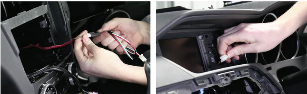
**11.** Schließen Sie die 2 Halterungen an beide Seiten des Bildschirms an, indem Sie die Halterung auswärts rein drücken.
