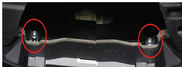
4. Entfernen Sie nun das Radio und die entsprechenden Anschlüsse inklusive der Anschlüsse für die Armatur.
