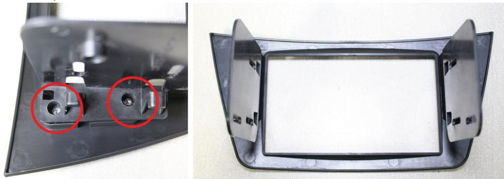
8. Gleiten Sie die Armatur zusammen mit der Halterung an das Radio und schrauben Sie die Halterung an. Stellen Sie bitte sicher, dass die Halterung bündig in der Position sitzt.
