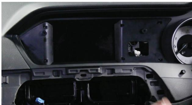
**12.** Entfernen Sie an der Unterseite des Panels (OEM Radios) die 4 Schrauben um den Panel zu entfernen.
