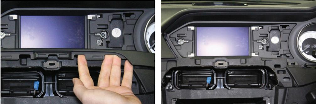
**10.** Verbinden Sie das Verlängerungskabel mit dem weißen OEM-Anschluß, welchen Sie vorher von dem Panel des Radios entfernt haben. Führen Sie das Kabel so ein, dass der weiße Anschluß rechts an der Seite des Bildschirms raus kommt.
