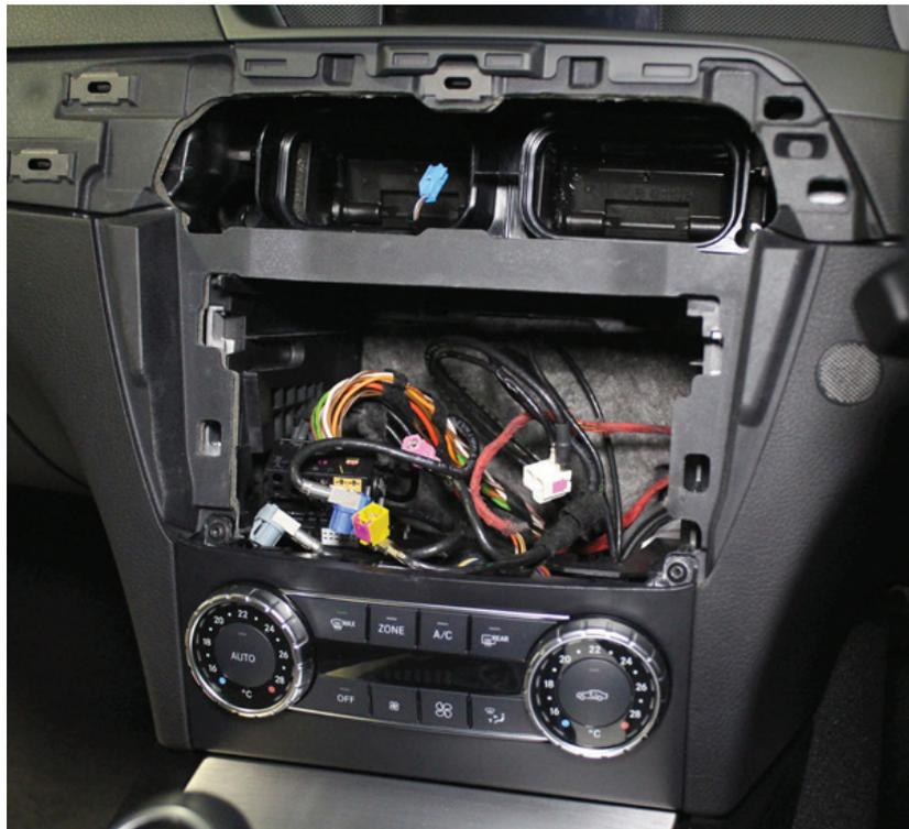
6. Um das Display Panel zu entfernen ( beide Seiten), drücken Sie bitte den Panel und drücken Sie dann in Richtung des Bildschirms.
