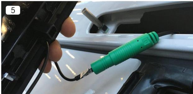
5. 3.5 mm Klinkenstecker Ausgang vom Kamerasensor an das grüne Gegenstück am Hauptkabel anstecken und mit Isolierband dicht umwickeln um das Eindringen von Wasser zu verhindern
