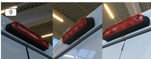
9. Ausrichten der Kamera-Kugel unten am Hauptgehäuse, mit dem beiliegenden U-förmigen Werkzeug, falls nötig
