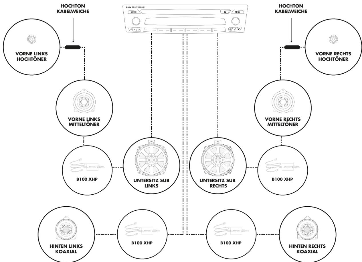
Bei nicht vorhandener Aktiv-Filterung (passiver Anschluss am Serienradio ohne Verstärker) muss bei den Mitteltönern die BMW Hochpassfrequenzweiche B100 XHP verbaut werden!
