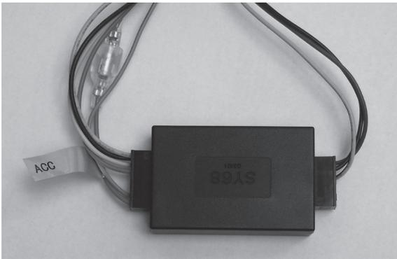
Verbinden Sie nun beide 12poligen Stecker des Hauptanschlusskabels mit dem CAN/Stalk Interface, wie im Bild zu sehen. Beide 12 Pol Stecker müssen hörbar einrasten, sie sind jeweils unterschiedlich gross. Verpolung oder falscher Anschluss dieser Stecker am Interface ist daher nicht möglich.
