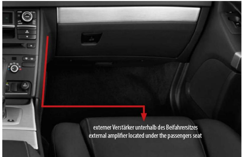
15) Nun bitte den Sitz zurückfahren, den Verstärker abschrauben, alle Verbinder ausstecken und die passenden Gegenstücke des Lenkradfernbedienungskabelsatzes (4) auf die Originalstecker stecken. Bitte auch den Lichtleiterring mit der Lichtleiterschleife (5) „abschließen“.
