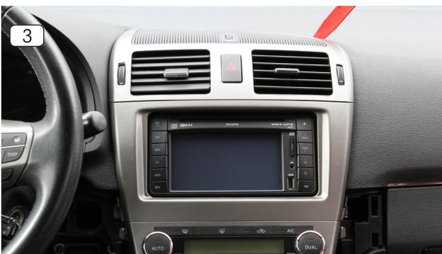
3. Hebeln Sie die Radioblende/Lüftungsdüse zuerst oben aus seiner gesteckten Verankerung. Fahren Sie mit dem Hebelwerkzeug einmal von rechts nach links um den Plastikrahmen.
