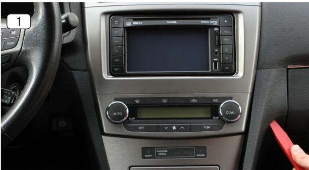
1. Hebeln Sie, wie in der Abbildung gezeigt, die Plastikabdeckung rechts von der Mittelkonsole aus seiner gesteckten Verankerung. Für diesen Schritt benötigen Sie ein Hebelwerkzeug aus Kunststoff.
