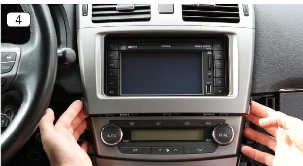
4. Lösen Sie den unteren Teil der Blende aus seiner Verankerung. Auf der Rückseite der Blende befindet sich ein Anschluss für den Warnblinkschalter. Diesen müssen Sie abstecken, bevor Sie den Plastikrahmen vollständig entfernen.
