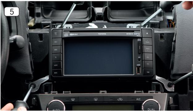
5. Lösen und entfernen Sie die vier Kreuzschlitz- (PH2) oder Sechskant- (10mm) Schrauben vom Originalgerät.
