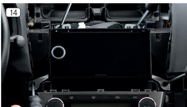
14. Verlegen Sie die diversen Anschlusskabel des ZENEC-Systems sorgfältig im unteren Bereich der Radioschachts. Schieben Sie anschließend das ZENEC-System vorsichtig und mit dosierter Kraftaufwendung zurück in den Radioschacht. Verschrauben Sie es wieder mit den vier Kreuzschlitz- (PH2) oder Sechskant- (10mm) Schrauben.
