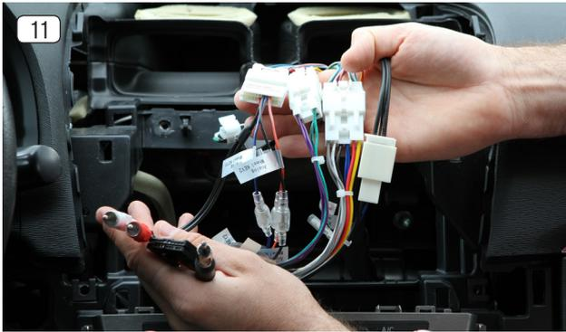
11. Verbinden Sie das Hauptanschlusskabel (Nr. 2) des ZENEC-Systems (Nr. 1) mit den beiden Radiosteckern des Fahrzeugs.
