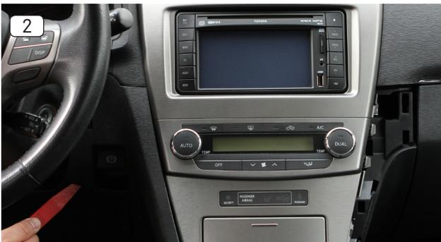
2. Hebeln Sie, wie in der Abbildung gezeigt, die Plastikabdeckung links von der Mittelkonsole aus seiner gesteckten Verankerung. Für diesen Schritt benötigen Sie ein Hebelwerkzeug aus Kunststoff.
