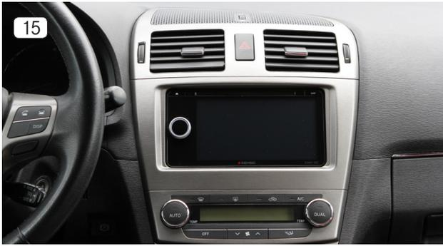
15. Nachdem das ZENEC-System wieder verschraubt wurde, müssen Sie die Radioblende aufstecken. Achten Sie darauf, dass Sie vorher auf der Rückseite der Radioblende den Stecker für den Warnblinkschalter wieder anschliessen. Um die Montage zu beenden, müssen Sie jetzt nur noch die Plastikabdeckungen links und rechts von der Mittelkonsole aufstecken.
