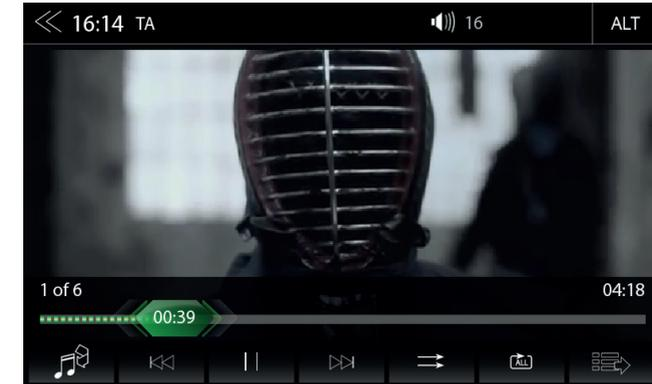
Für die Videowiederegabe ab USB / DVD muss das Parking Kabel bei der Gerätemontage angeschlossen werden. Ohne diese Verbindung bleibt der Bildschirm schwarz.
