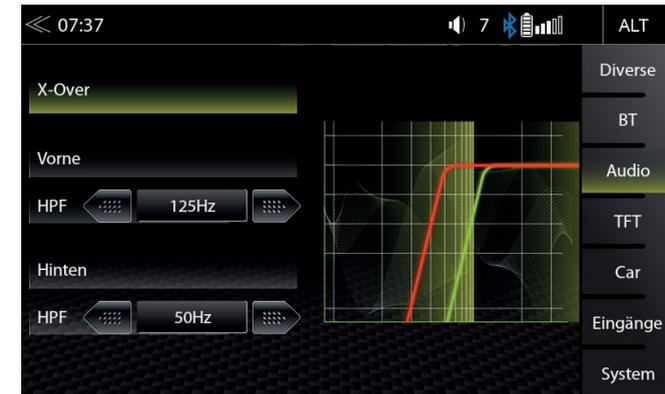
In diesem Expert Modus Menü können Sie die Hochpass Übergangsfrequenzen der vorderen und hinteren Lautsprecher einstellen. Die Werkseinstellung ist OFF (AUS).
