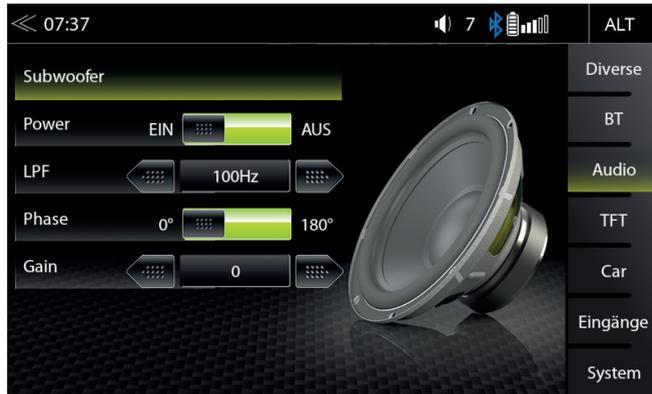
In diesem Expert Modus Menü können Sie die Phase, den Gain und die Tiefpass Übergangsfrequenz des Subwoofers einstellen. Die default Einstellungen sind Phase 0°, Power ON, LPF 100 Hz.
