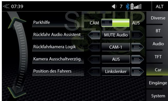
Im Car Setup Menü können Sie einstellen, wie das ZENEC Gerät auf im Fahrzeug vorhandene optionale Komponenten wie Kameras und Einparkhilfe interagiert. Zusätzlich kann eingestellt werden, ob das Fahrzeug ein Rechts- oder Linkslenker Modell ist.
