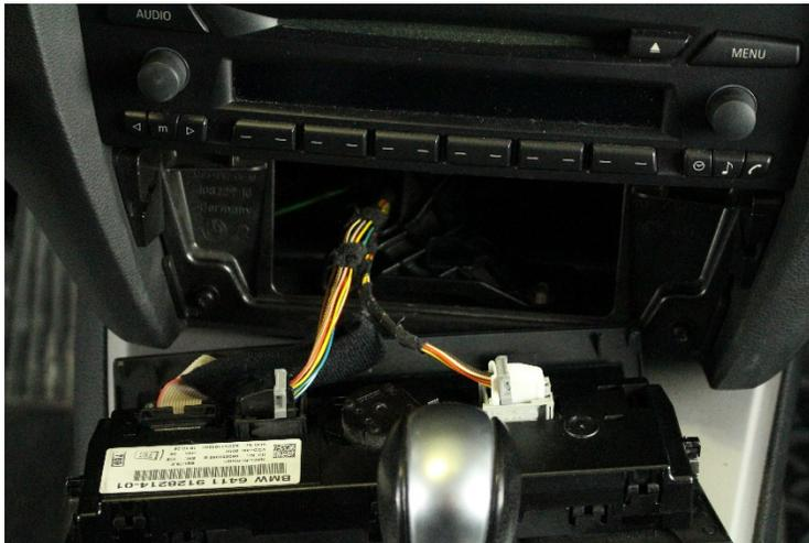
2. Ziehen Sie das Klimaautomatik Bedienteil aus dem Schacht und lösen Sie die Verriegelungen an den Steckern auf der Rückseite vom Klimabedienteil. Ziehen Sie nun alle Stecker ab. Entnehmen Sie das Klimaautomatik Bedienteil und die Optionstastenleiste aus dem Montagerahmen. Legen Sie das Bedienteil zur Seite.
