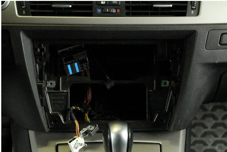
4. Lösen Sie die vier Schrauben vom inneren Kunststoffrahmen.
