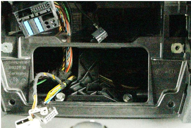
5. Lösen Sie die zwei Schrauben unten am Kunststoffrahmen. Entfernen Sie den Kunststoffrahmen aus der Mittelkonsole. Dieser wird, ausser für Remontage vom CD Originalgerät, im weiteren Verlauf nicht mehr benötigt.
