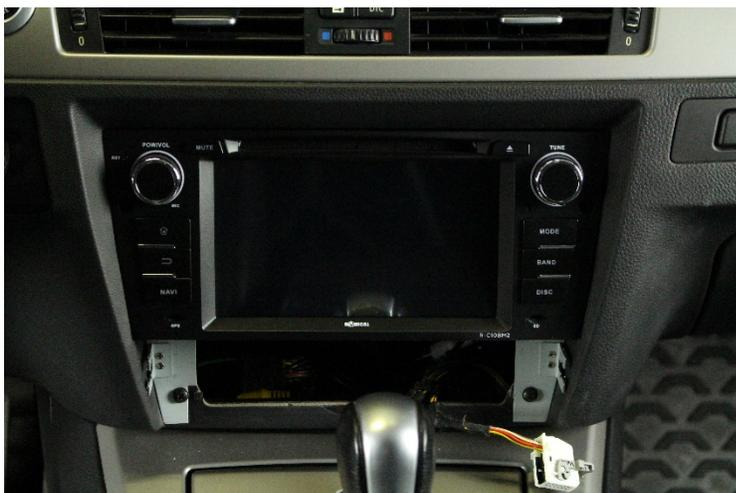
8. Montieren Sie die beiliegende Montagerahmen aus Metall (Nr. 17/18) mit den zwei Originalschrauben im Montageschacht. Verbinden Sie alle zuvor in den Radioschacht verlegten Kabel und die originalen Antennenkabel mit dem Radical-Gerät (Nr. 1). Führen Sie den R-C10BM2 in den Schacht ein und befestigen Sie das Gerät mit den zwei im Set Umfang enthaltenen Schrauben.
