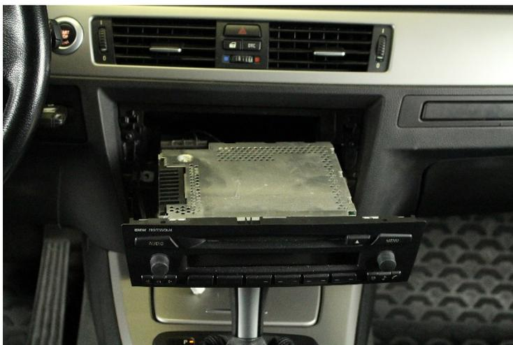
3. Lösen Sie die zwei Befestigungsschrauben unterhalb des CD Radios. Ziehen Sie das Gerät aus dem Schacht und lösen Sie den Quadlockstecker und alle weiteren Stecker und Kabel wie z.B. UKW Antenne etc. Legen Sie das Originalradio zur Seite, um es vor Beschädigungen zu schützen.
