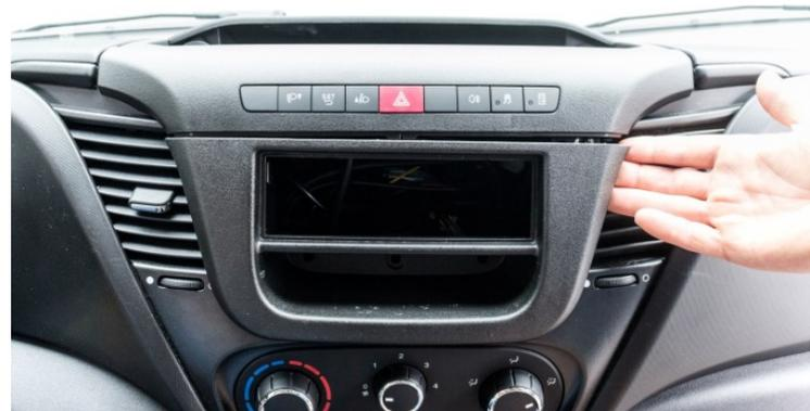
Der rot Markierte Bereich muss herausgeschnitten werden, damit ein Doppel Din Radio montiert werden kann.
