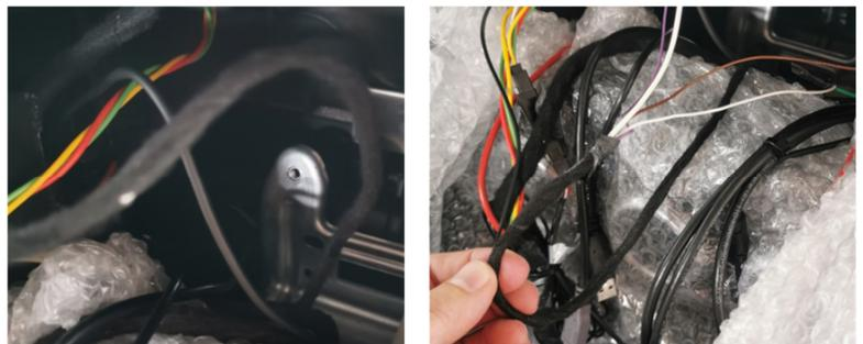
**Sollten die Lenkradtasten nicht richtig funktionieren, müssen die Kabel LFB 1 und LFB 2 vertauscht werden.**
