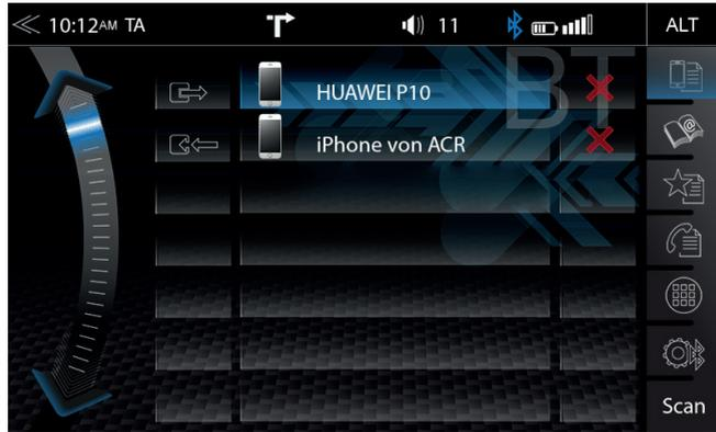
Damit ein Smartphone via Bluetooth mit dem Gerät verbunden werden kann, muss es einmalig erfolgreich gepairt werden.
