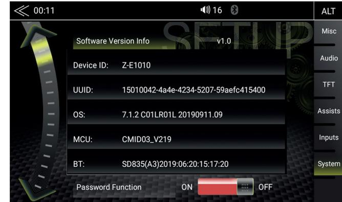
Im System Setup Menü unter Software Version Info sehen Sie die sich aktuell auf dem E>GO Core befindliche Software, mit Versionsangaben zu MCU, OS, BT und UUID.
