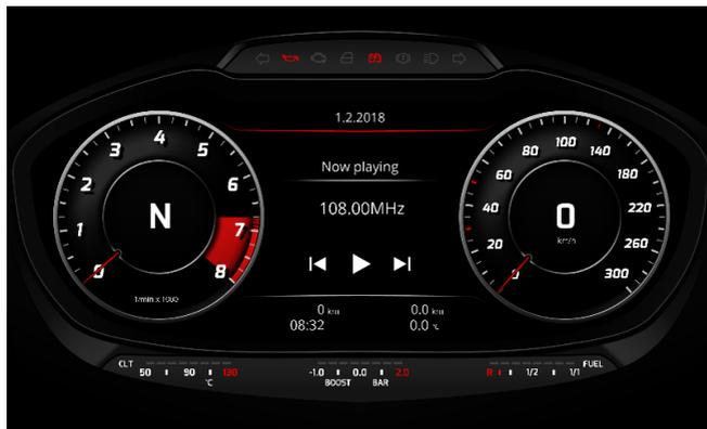
RealDash ist eine auf den ZENEC E>GO Core angepasste virtuelle Armaturenbrett App mit Performance-Meter-Anzeige. Die Daten werden über das OBD II Dongle an die App auf dem E>GO Core gesendet. In beinahe Echtzeit können Fahrzeug und Motordaten dargestellt werden, so z.B. Geschwindigkeit, Turbo Ladedruck, Öltemperatur, Tankfüllstand, Motordrehzahl etc. Es gibt mehrere Anzeige Templates zur Auswahl.
