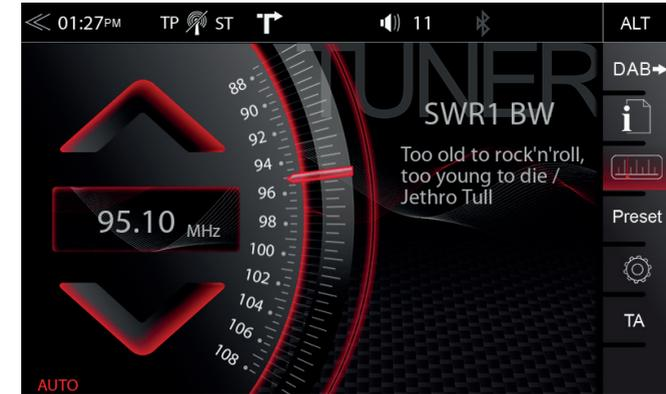
Im FM Setup (Zahnrad Icon) kann den Senderfrequenz-Pfeilen eine manuelle (100kHz Schritte), oder auto Scan Funktion (bis zum nächsten Sender) zugewiesen werden. Siehe S.18.
