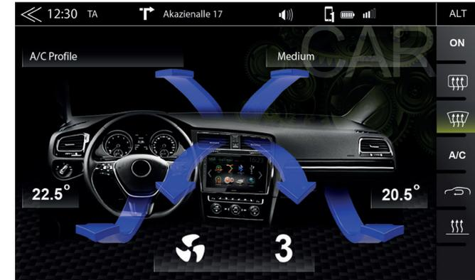
Steht AC Info auf EIN, werden bei drücken der Klima-Setup Taste aktuelle Werte der Klimaanlage im ZENEC-System angezeigt. Verschiedene Profile können dabei ausgewählt werden.
