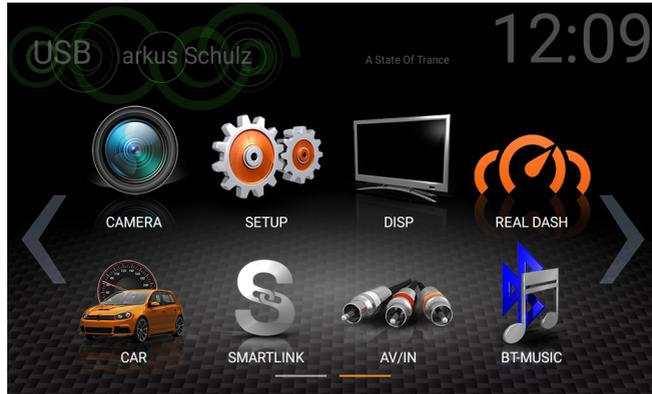
Mit dem Display Icon kann der LCD-TFT Bildschirm bei der Bildhelligkeit in zwei Stufen dunkler, bzw. ganz ausgeschaltet (Standby) werden. Dies erfolgt durch Antippen des Icons.
