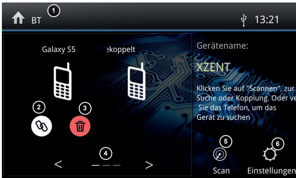
Bei der ersten Benutzung „koppeln“ Sie bitte zuerst ein kompatibles Telefon hinzu indem Sie einen SCAN/Suche auslösen. Stellen Sie sicher dass Ihr Smartphone „sichtbar“ ist und in der Suchliste auftaucht. Wählen Sie das Smartphone aus der Suchliste aus und bestätigen Sie den Passkey der Ihnen angezeigt wird damit die Kopplung zustande kommt.
