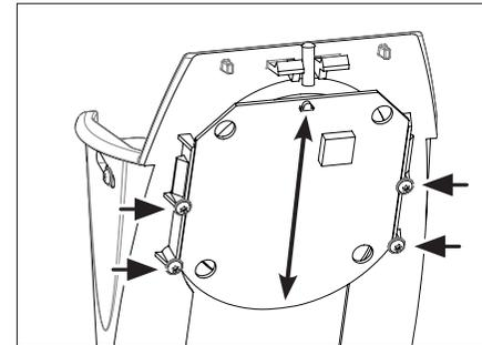
Sollte das Smartphone nicht geladen werden, kann bei Bedarf die Höhe der Platine des Inbay-Becherhalters eingestellt werden
