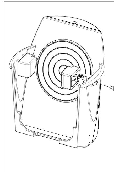
Mit den beiliegenden Klemmbacken kann für jedes Smartphone eine optimale Fixierung auch bei starken Querbeschleunigungen sichergestellt werden
