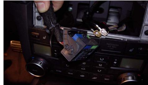
3. Die beiden zuvor aus dem Quadlock Stecker des Fahrzeugkabelbaumes entnommenen 12-Pin Einsätze in den Quadlock Stecker des Interfaces einstecken und dann den nun voll belegten Quadlock Stecker des Interfaces in die Quadlock Buchse des Interfaces einstecken.
