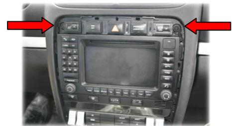
2. Navigationsystem herausziehen und alle Stecker lösen.
