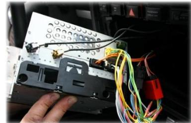
3. Den Kabelsatz TV-POR01 zwischen MINI-ISO-Stecker sowie Strom-ISO-Stecker und Navigation zwischen stecken.
