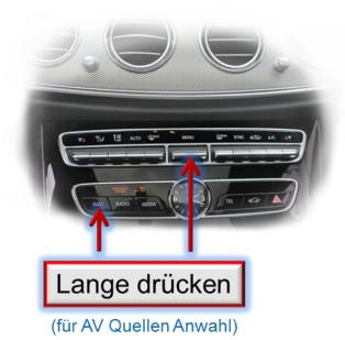
Die NAVI-Taste oder die MENU-Taste schalten den Eingang vom Werksvideo zu den eingespeisten Videoquellen um. Wenn alle Eingänge (per Dip Switch Einstellung) aktiviert sind, ist die Reihenfolge wie folgt:
