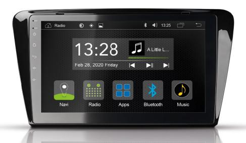
Innovativer fahrzeugspezifischer Android OS Infotainer mit kapazitivem 25,6 cm / 10,1" Touchscreendisplay: Der R-C11SK1 ist für den ŠKODA entwickelt – via CAN-Bus mit der Fahrzeugelektronik vernetzt, werden Komfortfunktionen wie die Anbindung an die Lenkradfernbedienung unterstützt.
