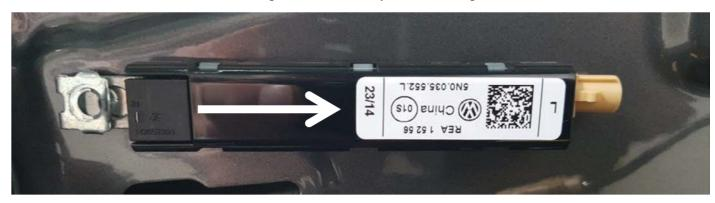
7. Mit der Nase wird der Verstärker zusätzlich an der Heckklappe gehalten With the extra nose the original amplifier gets extra stabilization.
