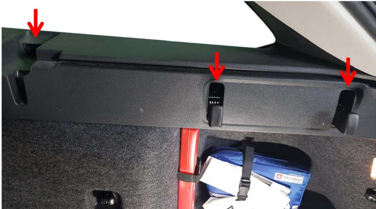
Die C-Säulenverkleidung zuerst unten lösen und danach oben herausziehen.
