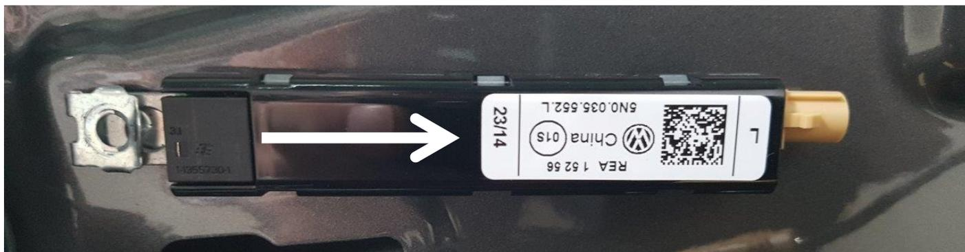
7. Mit der Nase wird der Verstärker zusätzlich an der Heckklappe gehalten.
