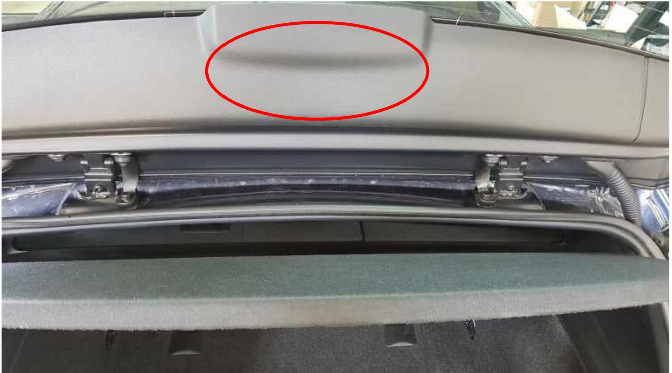
2. Die Heckklappenverkleidung entfernen. Diese ist mit 4 Klipps und Haltenasen befestigt.
