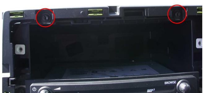
Die markierten Schrauben lösen und den Rahmen leicht nach vorne klappen.
