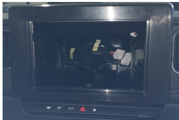
Abdeckblende drüber halten, aber nicht andrücken und einrasten lassen. Überprüfen, ob Metallrahmen zentral hinter der Abdeckblende sitzt, gegebenenfalls den Blechrahmen nachjustieren. Blende wieder entfernen und Schrauben anziehen.
