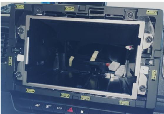
Blechrahmen ansetzen und Schrauben locker eindrehen.
