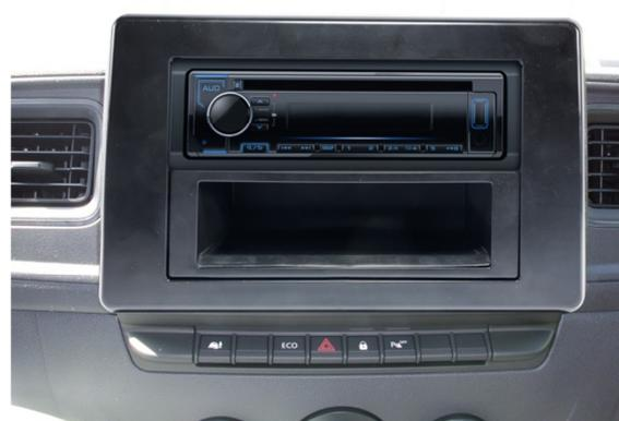
Wenn alle Schrauben wieder angezogen sind kann jetzt die Blende endgültig aufgesetzt werden. Jetzt müsste eindeutig zu hören sein, wie die einzelnen Rastnasen einklicken. Blechrahmen vom neuen Radio einsetzen und Radio anschließen.
