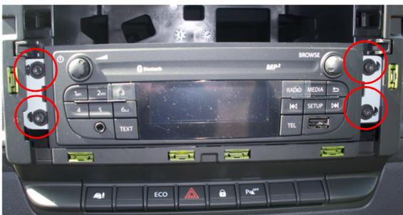
Schrauben vom Originalen Radio entfernen.
