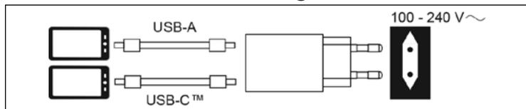
1. Schließen Sie Ihre mobilen Kleingeräte über ein USB-Ladekabel an das USB-Schnellladegerät an.
