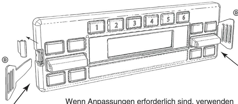
Wenn Anpassungen erforderlich sind, verwenden Sie die mitgelieferten DIN-Schlüssel (D), um das Radio aus dem Rahmen zu ziehen.
