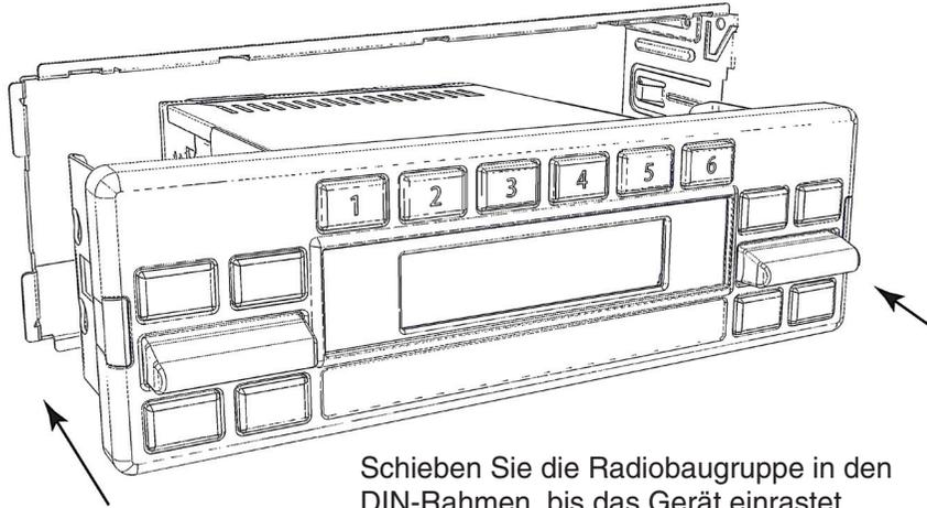
Schieben Sie die Radiobaugruppe in den DIN-Rahmen, bis das Gerät einrastet.
