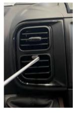
Die 4 Schrauben von der Blende lösen
