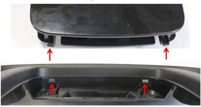
Anschließend die vordere Seite hineindrücken bis die Halteklammern einrasten. Dabei ist darauf zu achten das die Halteklammern hinter der Querstrebe nach unten geführt werden. Siehe Bild auf der nächsten Seite
