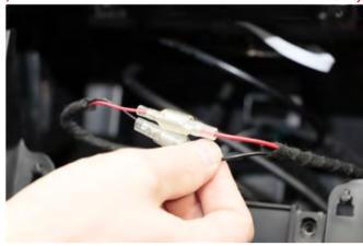
Die Zusatzkabel anschließen und die CARica in die Aussparung des originalen Ablagefaches einsetzen. Hierzu zunächst die hintere Seite mit den Führungsstiften einführen.
