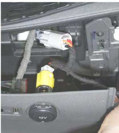
Den Stecker der 12V-Steckdose abstecken und mit dem Kabelsatz der CARica verbinden.
